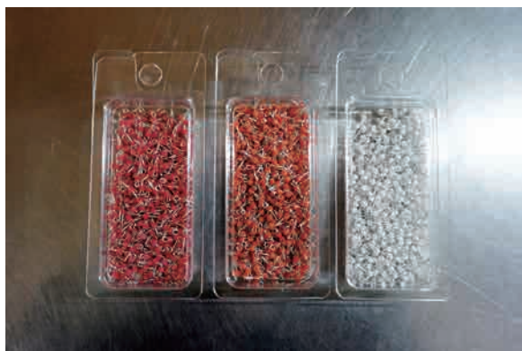
カウント対象物「チェック端子」 (マックエイト (MAC8) オシロブロープ用チェック端子 LC-33-S)
