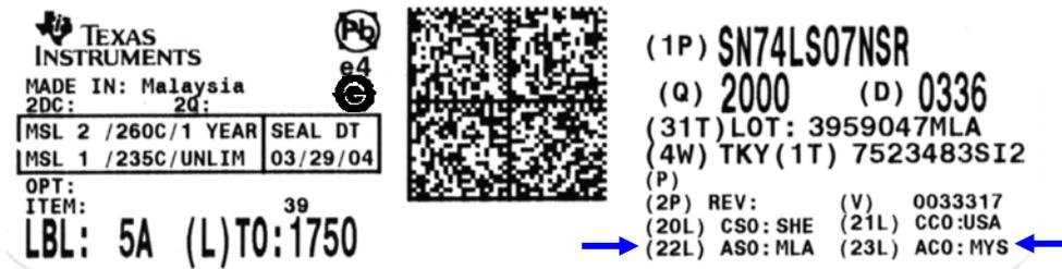
図1 出荷ラベルの表示箇所の例
